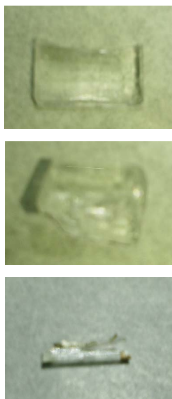
図1: 水溶液から育成したL体(上)およびD体(中央)、ラセミ体(下)のアラニン単結晶。
