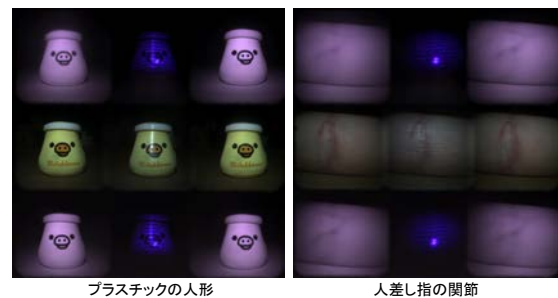
図5：プロトタイプにより撮影した画像例。異なるモードの画像が同時に得られる。
