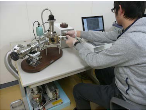
図4：試料加熱用の走査電子顕微鏡
