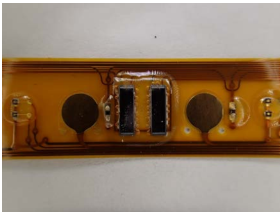
図3 実装された素子の写真。(左端からLED,電極,サーミスタ, フォトダイオードとなっている)
